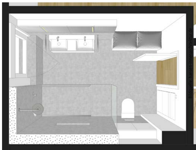
Variante 1: Das WC liegt an der linken Wand direkt am Schacht, die Dusche daneben ist mit 90 × 200 Zentimetern sehr großzügig bemessen.
