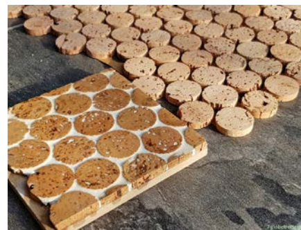
Das Korkmosaik besteht aus Endstücken, die bei der Produktion von Flaschenkorken anfallen.
