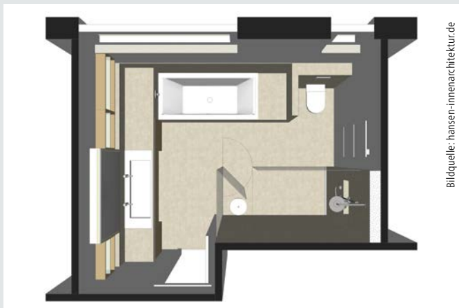
Variante 1 bleibt nah an der bestehenden Aufteilung. Der Waschtisch wird in eine durchgehende Ablage von Wand zu Wand integriert.
