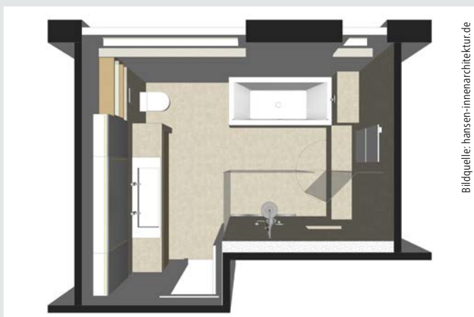
In der Variante 3 bleiben Waschtisch und WC wie in Variante 2. Wanne und Dusche sind getrennt mit dem Zugang in der Mitte.
