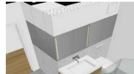
In der Variante 1 wird die Fläche über der Vorwand für einen Einbauschränk genutzt.
